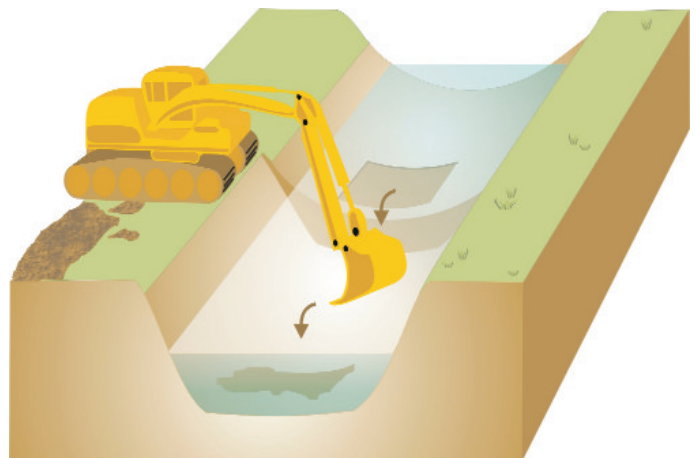
Fig.29 - Réensemencement à la pelle mécanique de la zone curée par épandage de la crème de vase ancienne.
