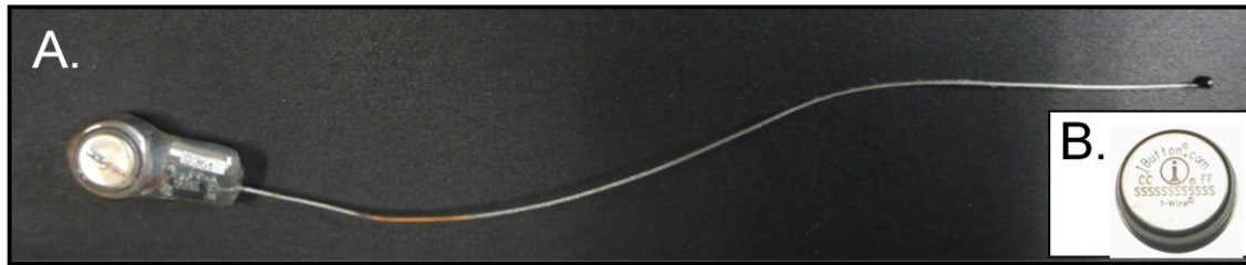
Figure 8. Matériel utilisé pour les suivis thermiques et télémétriques des couleuvres. A. Emetteur radio (R1650, Advanced Telemetry Systems, Isanti, USA), 2.2g ; B. Enregistreur automatique de température (8 kb iButton thermochron DS1922, Dallas Semiconductor, Dallas, USA), 17 x 6 mm, 4 g. Précision \pm 0.5^{\circ}\text{C} .
