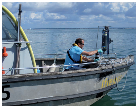
Photos 11 et 12. Remplissage des flacons à partir de la bouteille à prélèvement. À gauche : flacon pour les nutriments. À droite : flacon pour le phytoplancton.
