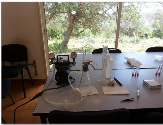
Figure 3 : Appareil de filtration pour l'analyse de la chlorophylle a.
