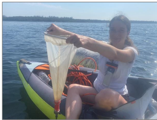
Figure 5 : Collecte du phytoplancton à l'aide du filet Apstein (soie de 20 \mu\text{m} ).
