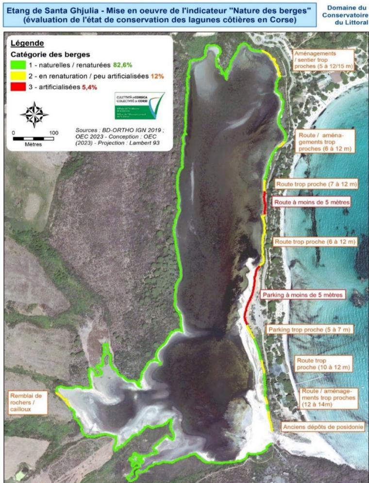
Figure 50. Cartographie détaillée de la nature des berges de la lagune de Santa Ghjulia réalisé par le gestionnaire du site en 2023 (© OEC, 2023)
