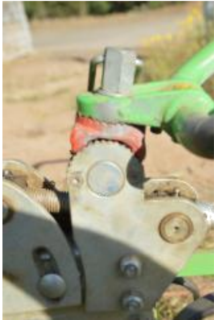
Figure 38 : Mécanisme de réglage des mancherons (photo Tiphaine Verdoux)
