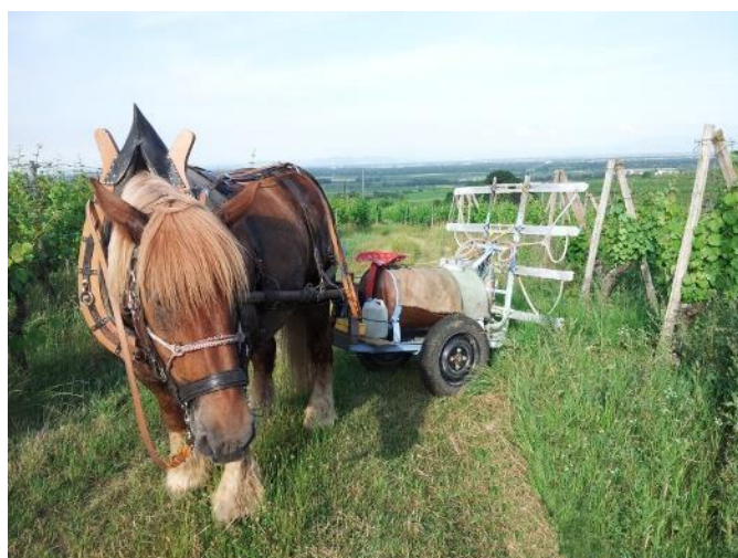
Figure 40 : Pulvérisateur à traction animale remis en état (Hauser, 2013)
