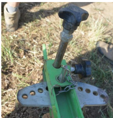
Figure 39 : Régulateur peu ergonomique (photo Tiphaine Verdoux)
