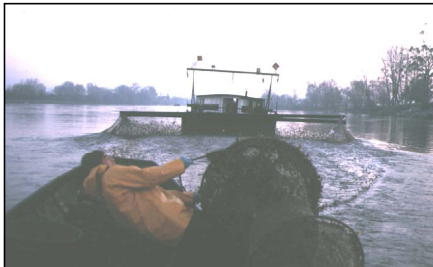
Photo 2 : Vue arrière de la toue au moment du lever du filet. On distingue sur la photo les deux pièces horizontales, permettant de maintenir la poche ouverte ou fermée, d'après Castelnaud et Babin (1992).
