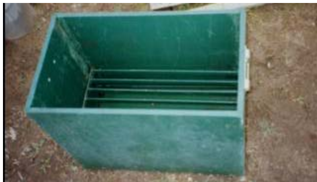
Photo 19 : Dispositif permettant de tester le passage d'individus à travers des grilles d'espacement variables.
